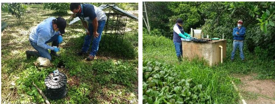
*Figura 1. Medición de la profundidad del pozo subterráneo. Recolección de muestras del vertimiento para analizar.*
